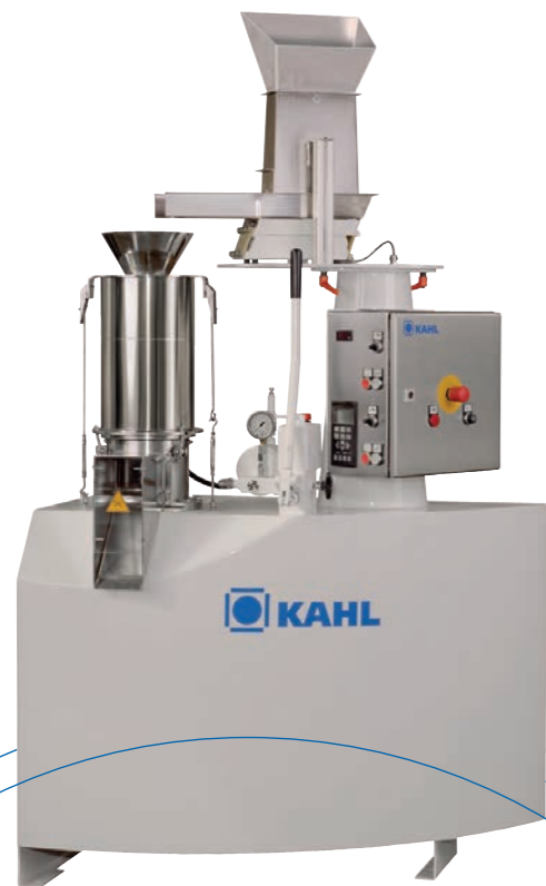
Presse à filière plate type 14-175 pour utilisation laboratoire ou pour de petites productions
