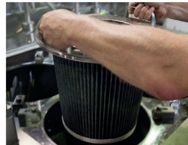
L'accès sur deux niveaux facilite le remplacement du filtre
