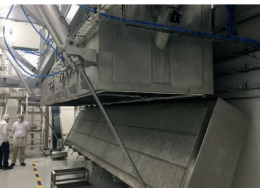
L'élément à lit fluidisé peut être basculé et permet ainsi l'accès au fond du tamis
