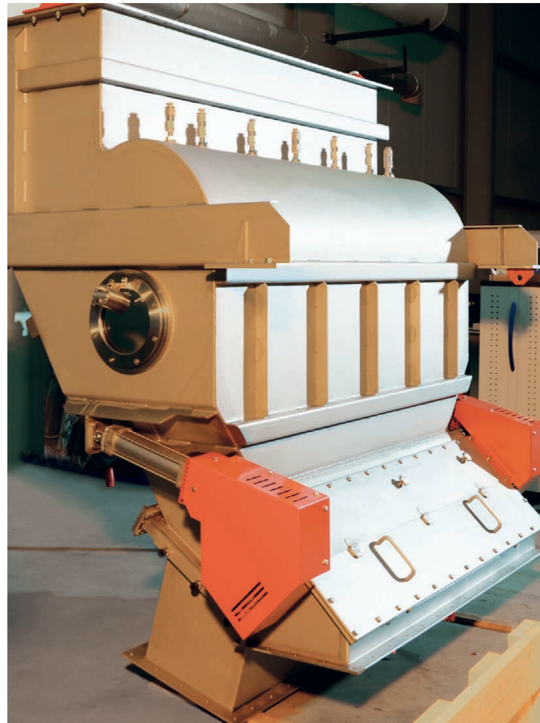
Le cœur d'une installation de torréfaction, le RFB
