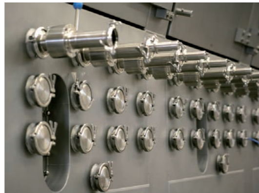
Buses télescopiques Les lances de pulvérisation peuvent être démontées pendant le fonctionnement et elles peuvent être installées à différentes positions en hauteur.
