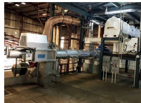
Extrudeur KAHL avec unité de conditionnement MK
