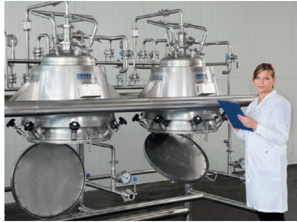
Unité-pilote d'extraction DEVEX
