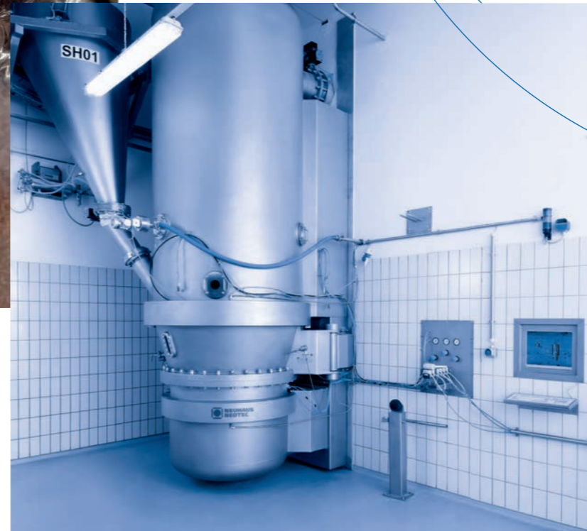
Le traitement par charges dans une installation Batch FB est particulièrement efficace si un changement fréquent de produits est prévu
