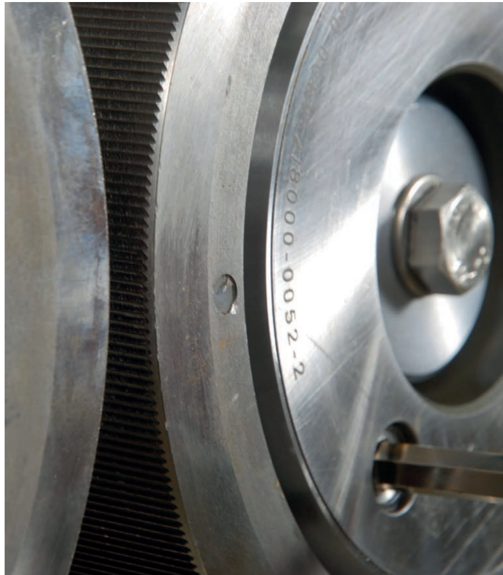
La vitesse et l'écart des cylindres sont réglables
