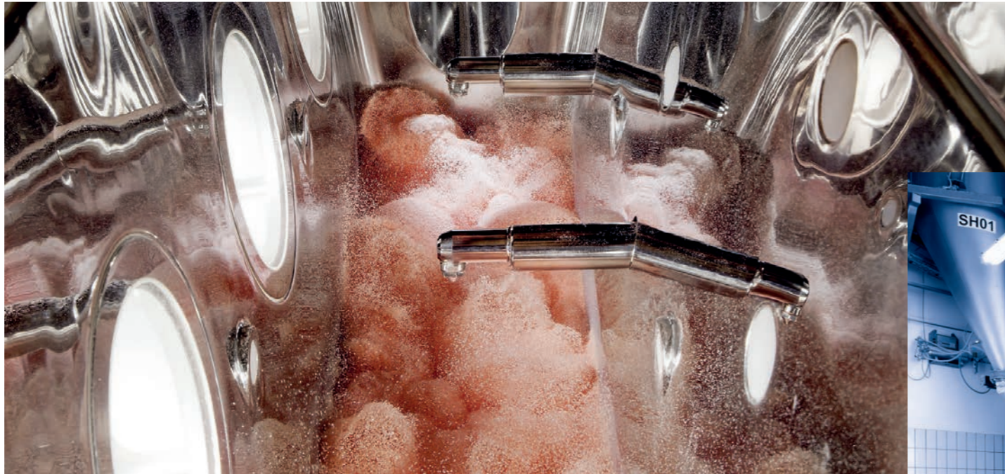
Les conditions dans le lit fluidisé sont optimales pour un échange effectif de chaleur et de matière
