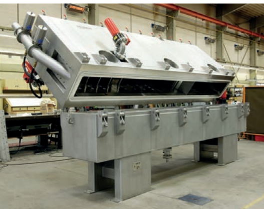
L'élément à lit fluidisé peut être basculé et permet ainsi l'accès au fond du tamis
