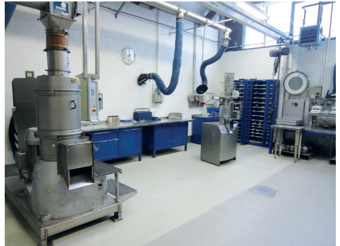
Vue dans l'installation pilote avec la presse de laboratoire 14-175 (à droite) et la presse 33-390 pour les petites productions
