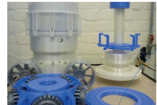
Fig. 2: Modelo de una prensa granuladora
