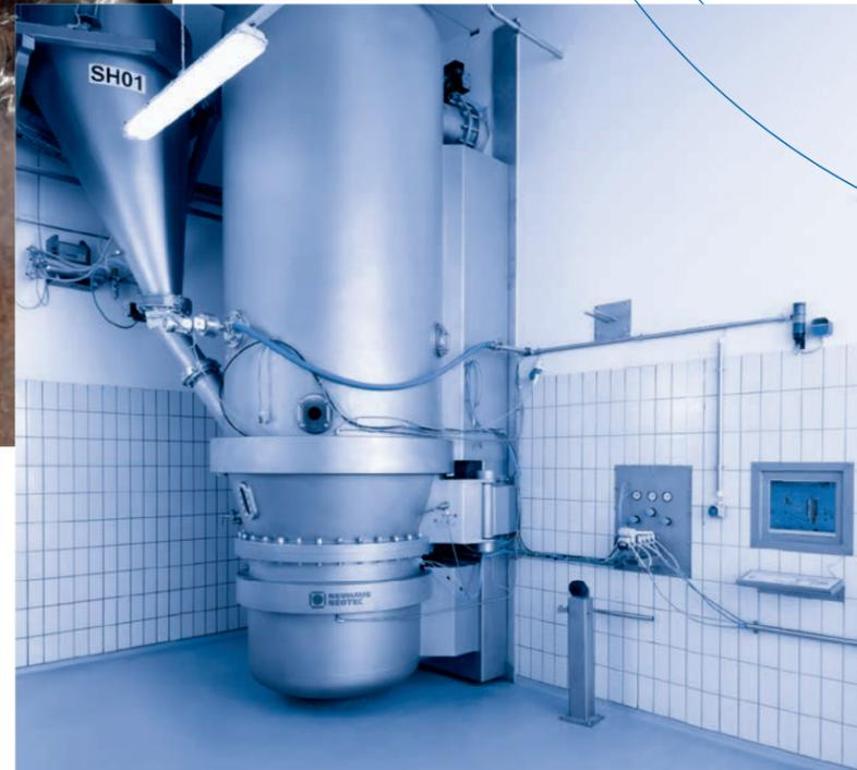
El procesamiento por cargas en una planta Batch FB es particularmente efectivo con cambios frecuentes de producto
