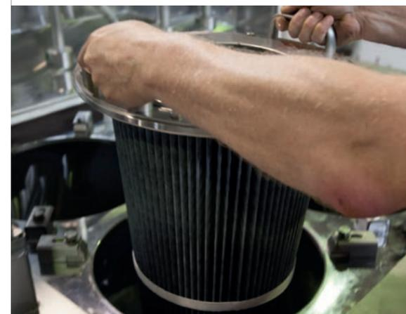
El acceso a dos niveles facilita el reemplazo del filtro, por ejemplo
