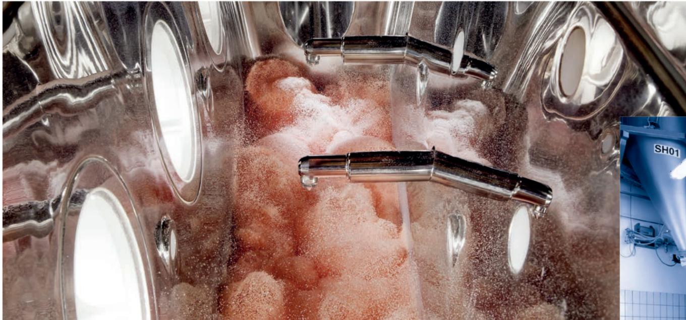
El lecho fluidizado proporciona las condiciones óptimas para un intercambio efectivo de masa y calor
