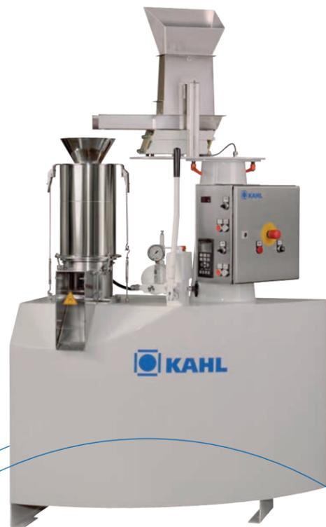
Prensa granuladora de matriz plana, tipo 14-175, para el uso en laboratorios o para producciones muy pequeñas
