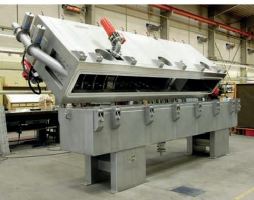
El elemento de lecho fluidizado puede inclinarse y permite el acceso al fondo perforado
