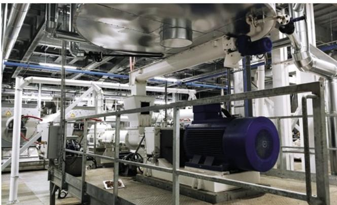
Hydrothermische Behandlung mit Reaktor und Ringspalt-Expander
