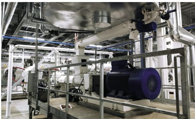
Traitement hydrothermique avec réacteur et expandeur à ouverture annulaire
