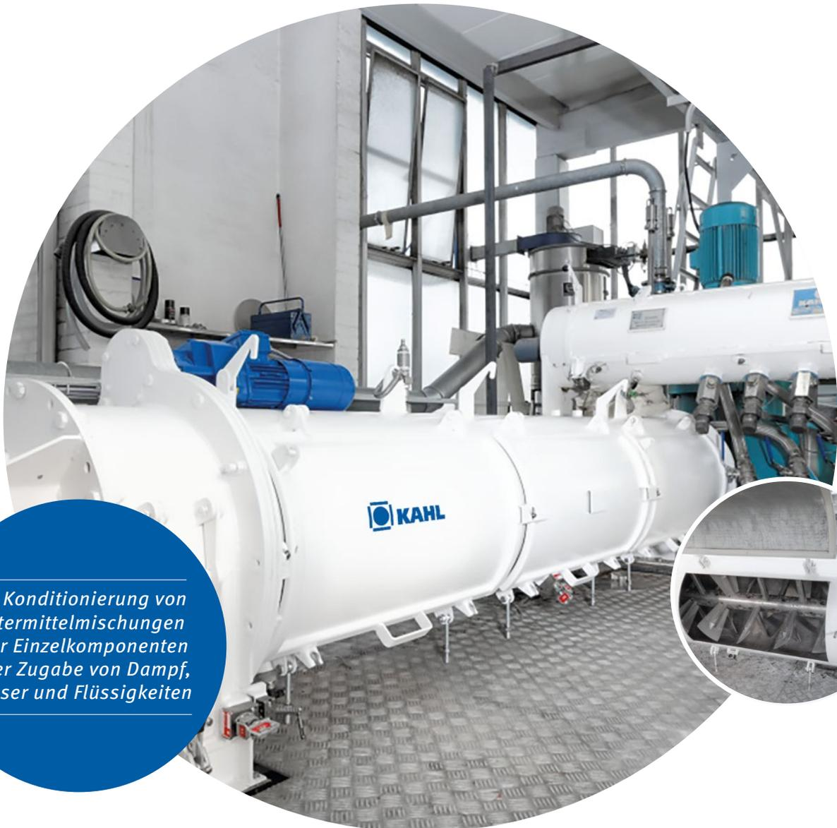
*Zur Konditionierung von Futtermittelmischungen oder Einzelkomponenten unter Zugabe von Dampf, Wasser und Flüssigkeiten*
